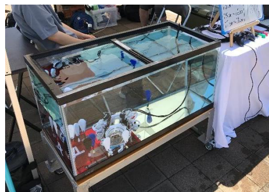
Fig. 3 教育用水中ロボット CHVIS(ちび) Fig. 4 ちびを利用したゲーム
